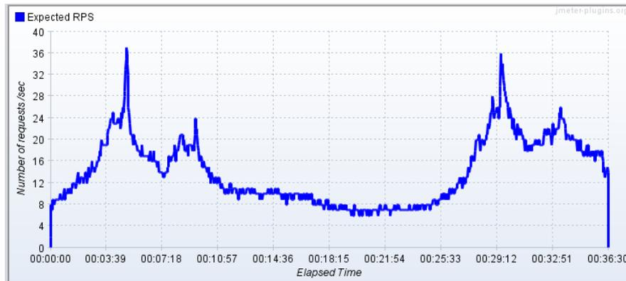
図 2.4: バックグラウンドトラフィックパターンの例
